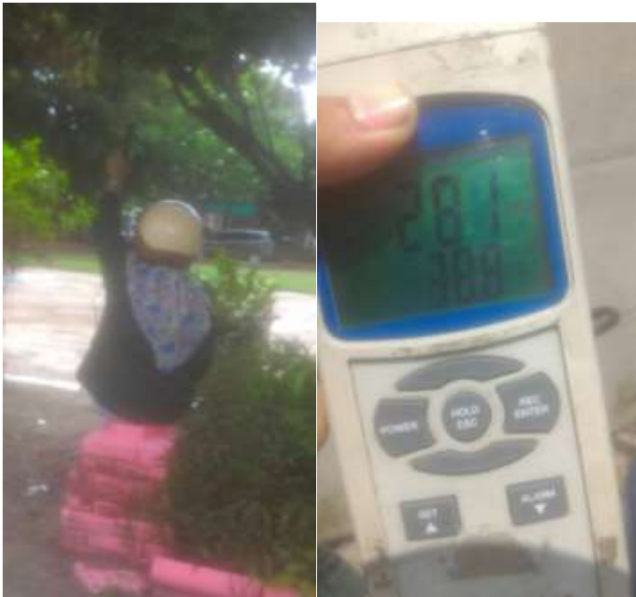
Gambar 4.3 Pengukuran CO 2 menggunakan CO 2 meter
