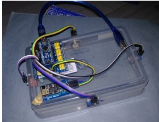
Gambar 4.5 Perangkat e-nose dengan 4 sensor MQ
