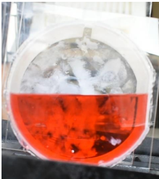
Gambar VI.16 Tangki Uji Bilobe Tanpa Baffle 50%, t: 8s
