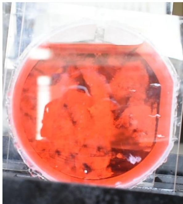
Gambar VI.24 Tangki Uji Bilobe Tanpa Baffle 90%, t: 8s
