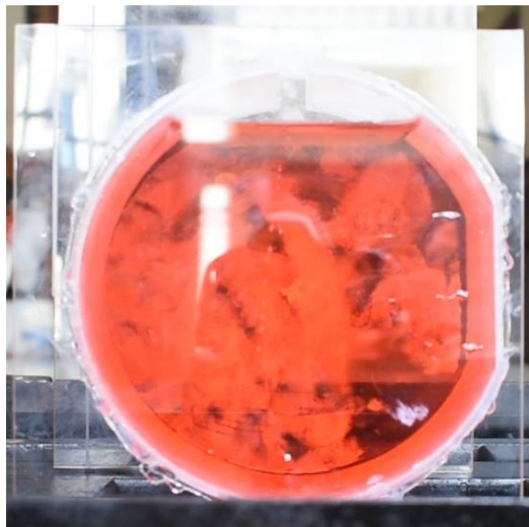
Gambar VI.22 Tangki Uji Bilobe Tanpa Baffle 90%, t: 6s
