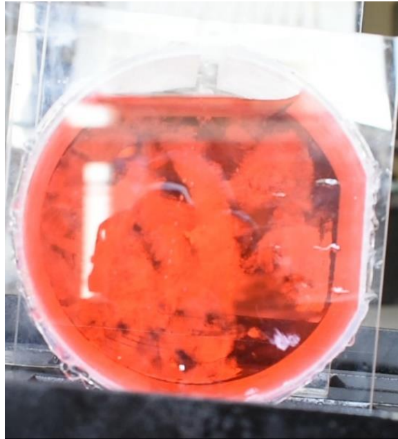
Gambar VI.23 Tangki Uji Bilobe Tanpa Baffle 90%, t: 7s
