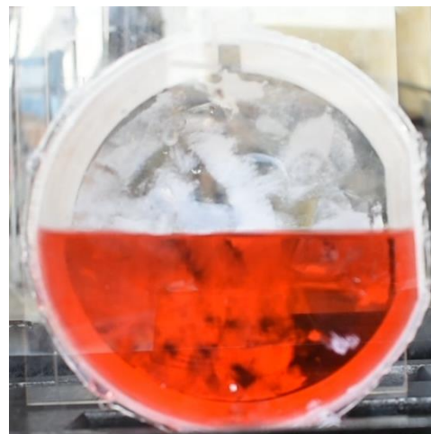
Gambar VI.12 Tangki Uji Bilobe Tanpa Baffle 50%, t: 4s
