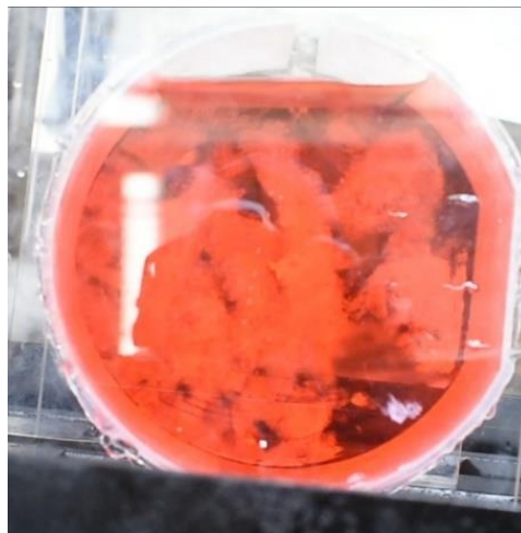
Gambar VI.18 Tangki Uji Bilobe Tanpa Baffle 90%, t: 2s
