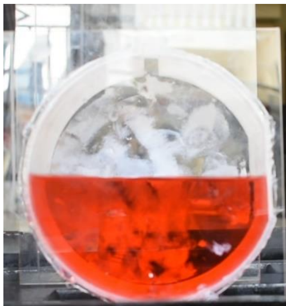
Gambar VI.14 Tangki Uji Bilobe Tanpa Baffle 50%, t: 6s
