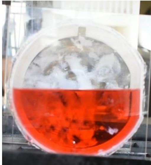
Gambar VI.15 Tangki Uji Bilobe Tanpa Baffle 50%, t: 7s
