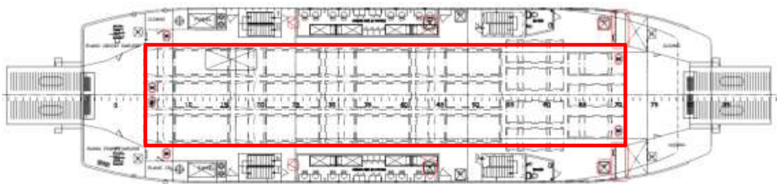
Gambar IV.3 Geladak Kendaraan Dengan Jumlah Lane yang Sama
