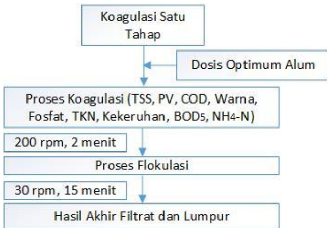
Gambar 3.8 Skema Koagulasi Satu Tahap
