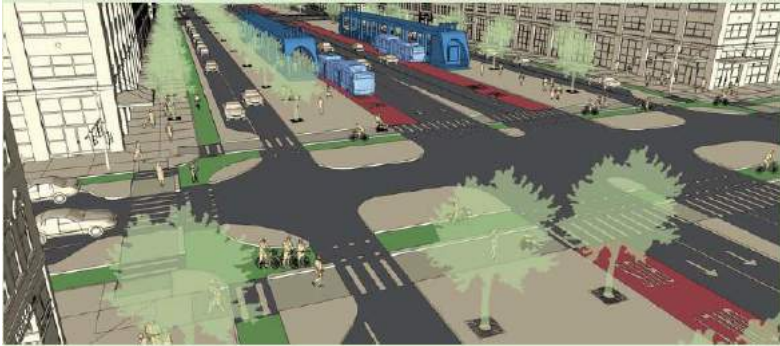
Gambar 2. 20 Penempatan Jalur Bus pada Sisi Luar Central Roadway pada Tipe Jalan Boluevard Sumber : BRT Standard , 2016
