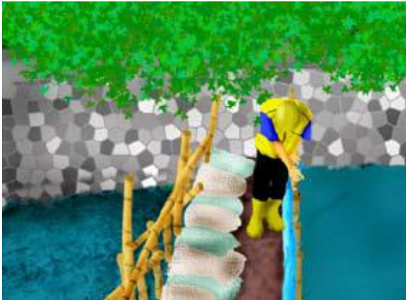
Gambar 6. 10 Proses pembuatan tanggul (kistdam)
