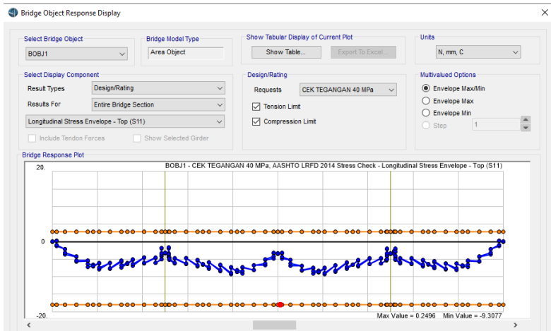
Gambar 4.42 Tegangan Sisi Atas Bentang Menerus Output CsiBridge
