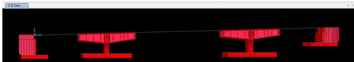
Gambar 4.18 Struktur Kantilever Tahap Pengecoran Segmen A5
