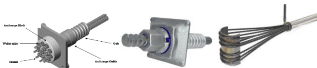
Gambar 2.7 Prinsip Pengankuran Tendon
