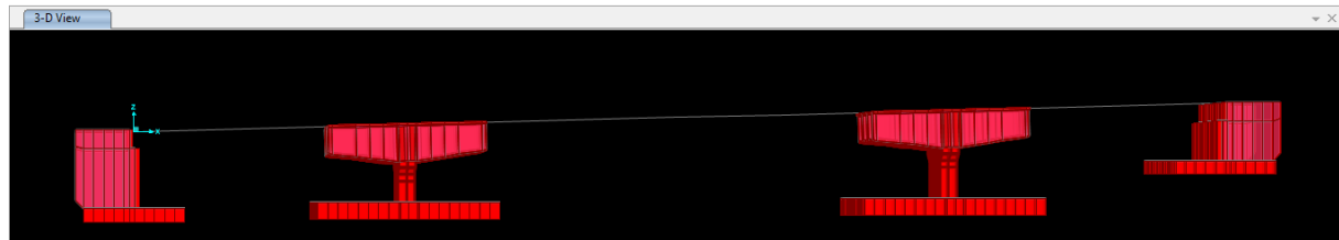
Gambar 4.15 Struktur Kantilever Tahap Pengecoran Segmen A4
