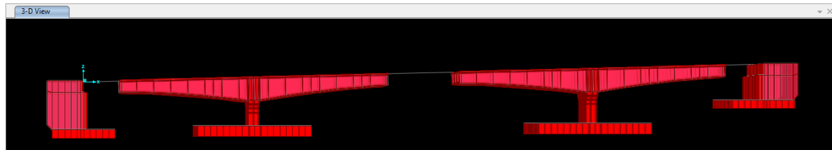
Gambar 4.30 Struktur Kantilever Tahap Pengecoran Segmen A9
