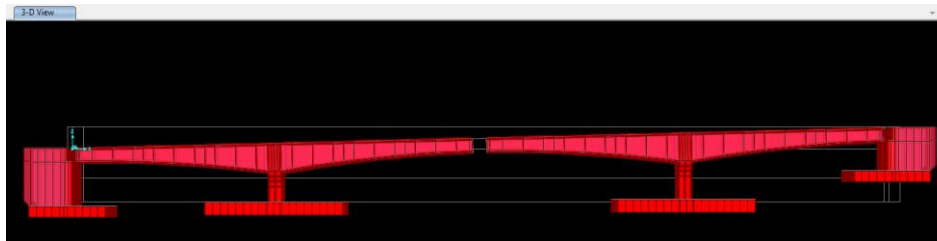
Gambar 4.36 Kantilever Tahap Pengecoran Segmen CL
