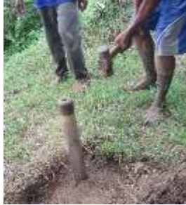
Gambar 4.3 Pengambilan Tanah Undisturbed dengan menggunakan tabung Shelby . (Sumber : Dokumentasi Pribadi)
