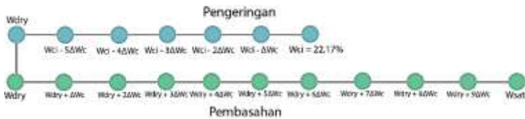
Gambar 3. 7 Skema proses pengeringan dan pembasahan berulang pada tanah remolded campuran kapur. (Sumber : Data Primer)
