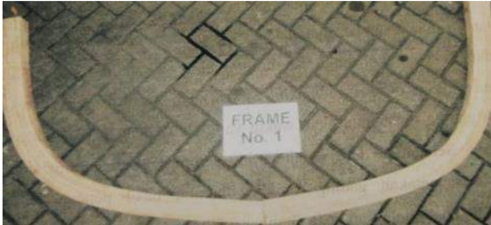
Gambar 2.17 Hasil proses fabrikasi gading (Supomo, 2016)
