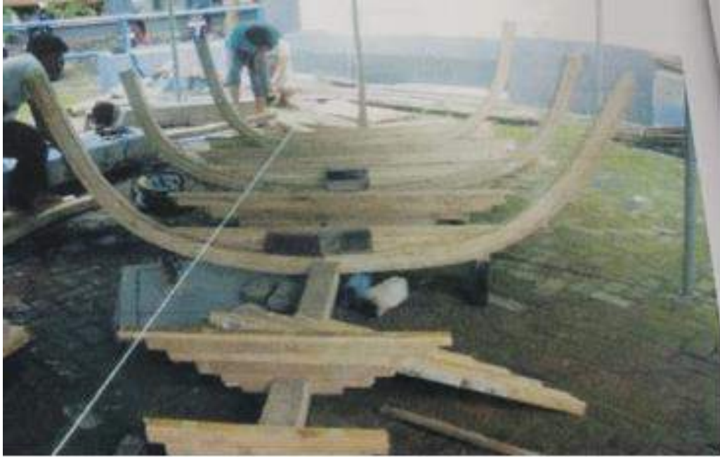
Gambar 2.22 Pemasangan dan pengikatan gading dan wrang (Supomo, 2016)
