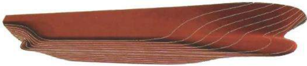
Gambar 2.9 Bentuk buttocks kapal (Dokkum, 2003)
