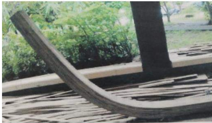
Gambar 2.16 Hasil pembuatan lunas menerus sampai linggi haluan (Supomo, 2016)
