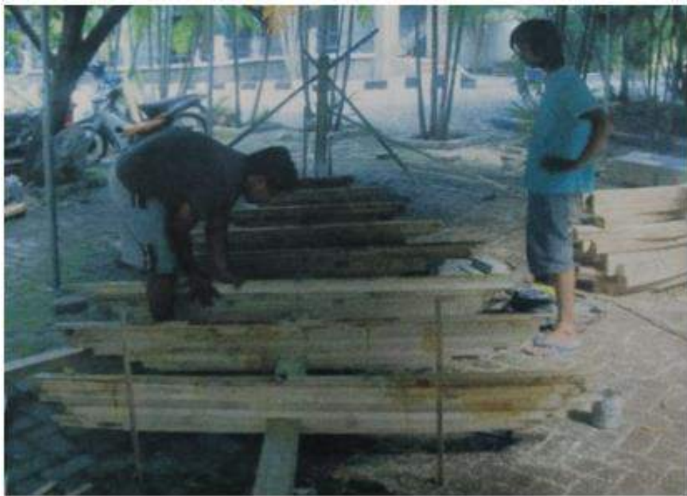
Gambar 2.21 Proses penimbangan wrang dengan lunas dan pengikatnya (Supomo, 2016)
