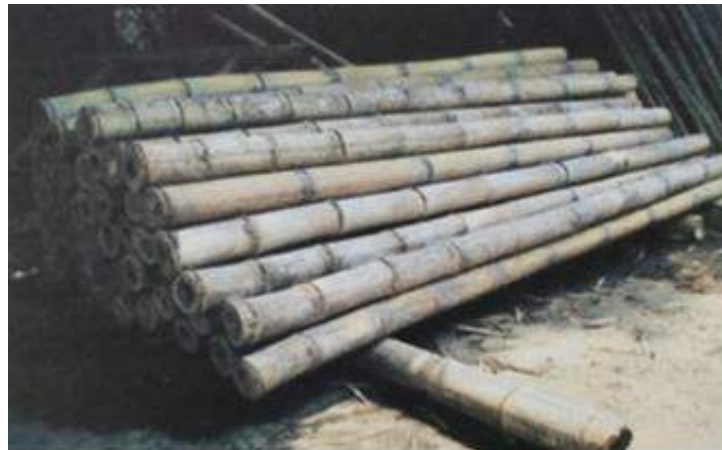
Gambar 2.15 Hasil potongan batang bambu dengan panjang 4m (Supomo, 2016)
