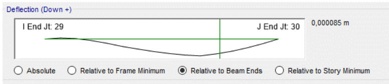
Gambar 4.52 Lendutan yang terjadi pada ETABS
