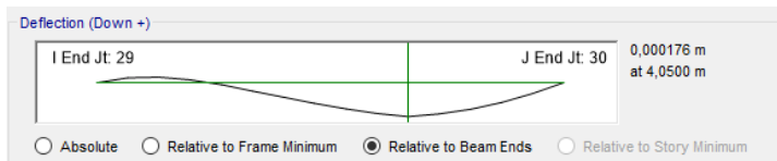
Gambar 4.55 Lendutan yang terjadi pada ETABS
