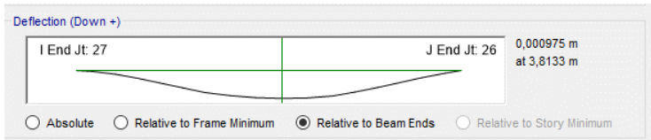
Gambar 4.48 Lendutan yang terjadi pada ETABS
