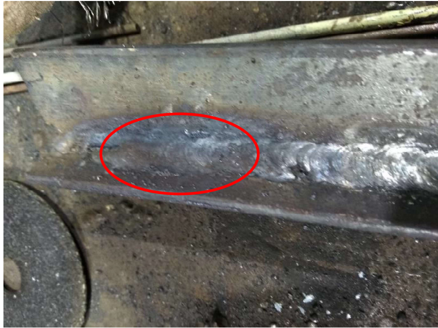
Gambar 4.15 Hasil Pengelasan dari Jarak Busur yang Lebih Panjang
