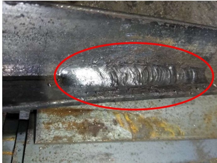
Gambar 4.17 Hasil Pengelasan dengan Jarak Busur Sesuai
