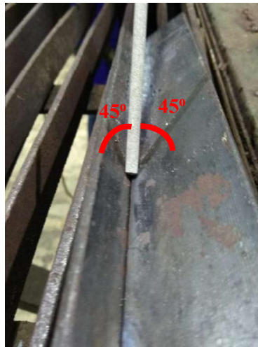
Gambar 4.20 Posisi Elektrode Terhadap Masing-masing Pelat
