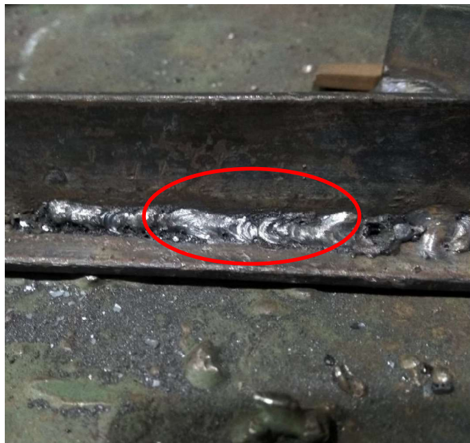
Gambar 4.16 Hasil Pengelasan dari Jarak Busur yang Lebih pendek
