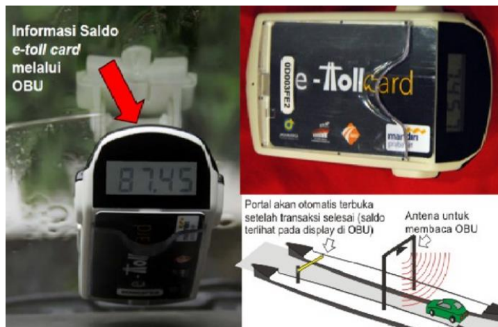
Gambar 2.11 Perangkat On Board (OBU) dan sistem pembayaran OBU
