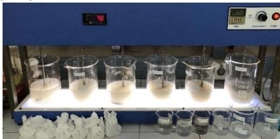
**Gambar 4.3 Proses Jar Test Saat Waktu Kontak 90 Menit**
