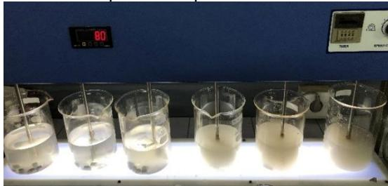
**Gambar 4.2 Proses Jar Test Saat Waktu Kontak 30 Menit**
