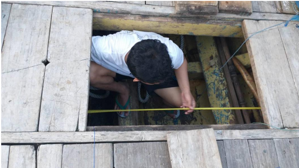
Gambar A. 2. Pengukuran offset lambung kapal
