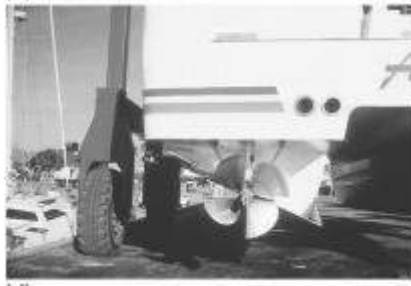
(d) surface piercing propeller
