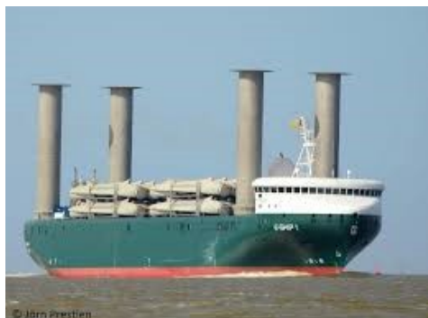
Gambar I-2 E-ship 1, Contoh Kapal dengan Flettner Rotor (Marineinsight, 2013)
