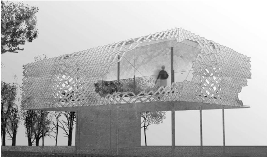
Gambar 2.32 Konsep evaporative skin yang diaplikasikan pada elemen selubung bangunan (Ripple, 2014)
