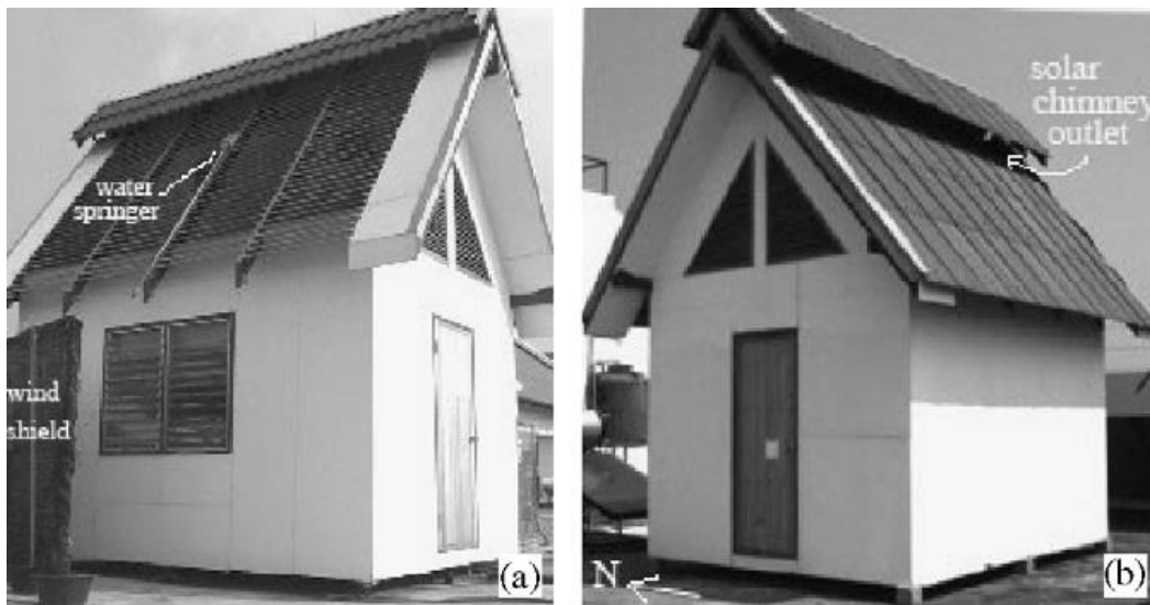
Gambar 2.28 Penelitian eksperimental water spray yang dialirkan pada atap (Chungloo, 2007)
