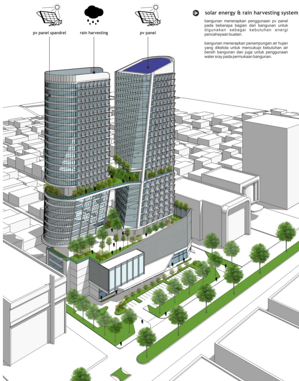
Gambar 5.49 Gedung kantor menerapkan solar collector dan juga rain harvesting system pada bangunan
