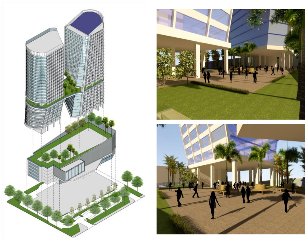
Gambar 5.46 Skycourt sebagai area atau ruang interaksi pengguna kantor sewa dan juga sebagai aliran udara pada bangunan
