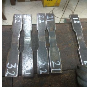
Gambar III.10 Spesimen Uji Tarik
