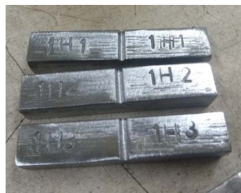
Gambar III.11 Spesimen Uji Impact
