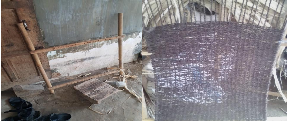
Gambar 3.5 Proses Penganyaman Serat Ijuk menjadi Woven roving
