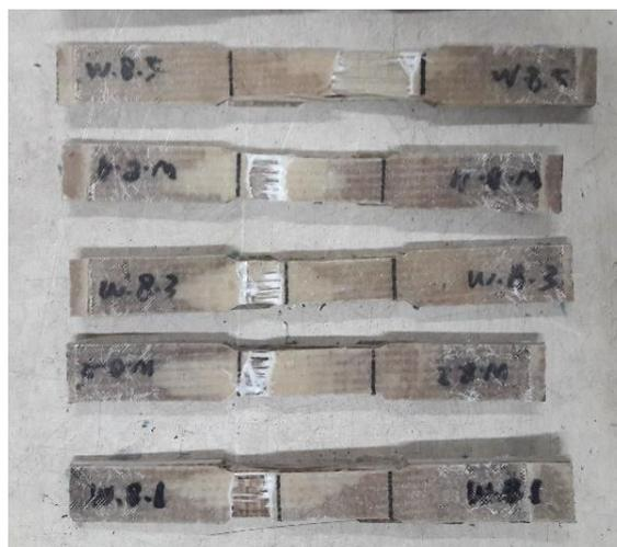
Gambar 4.9 Dokumentasi pengujian tarik variasi *core material* kayu Waru 6 mm
