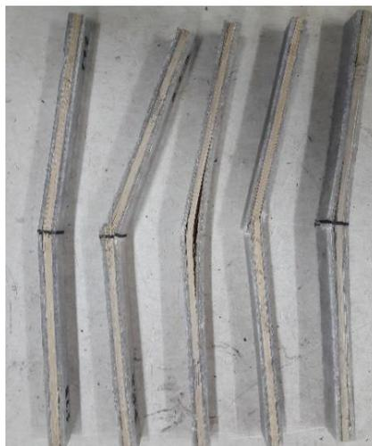
Gambar 4.25 Dokumentasi pengujian tekuk variasi *core material* kayu Waru 8 mm
