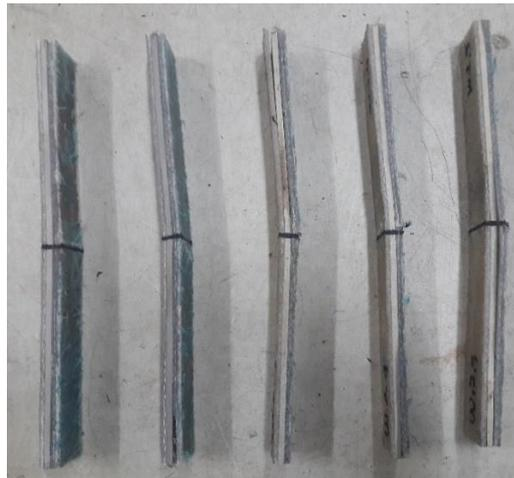
Gambar 4.19 Dokumentasi pengujian tekuk variasi *core material* kayu Waru 2 mm
