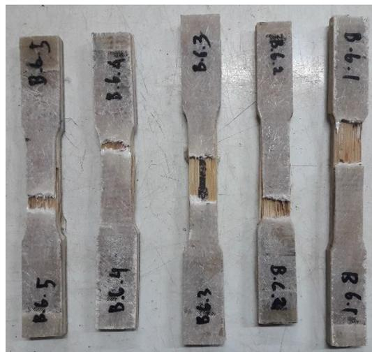
Gambar 4.15 Dokumentasi pengujian tarik variasi *core material* bilah Bambu 6 mm
