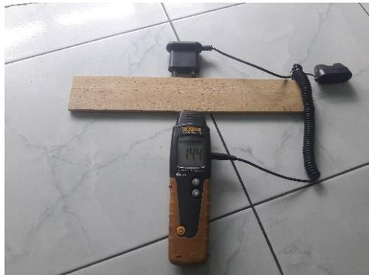
Gambar 3.8 Proses Pengukuran Kadar Air Material Kayu
