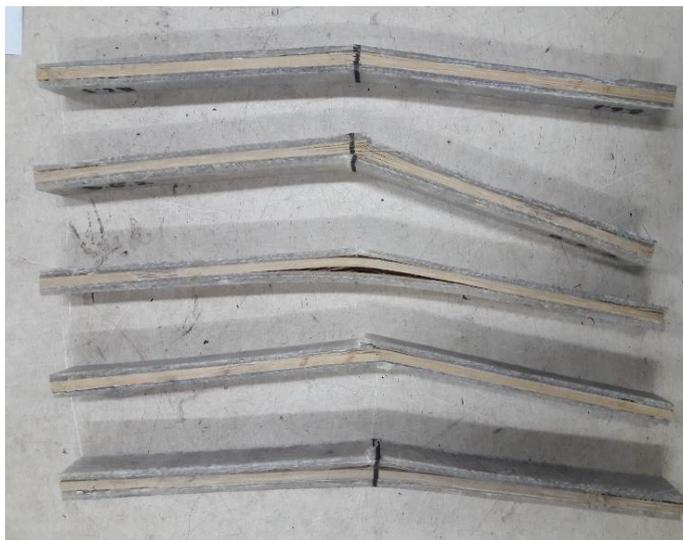
Gambar 4. 31 Dokumentasi pengujian tekuk variasi *core material* bilah Bambu 6 mm
