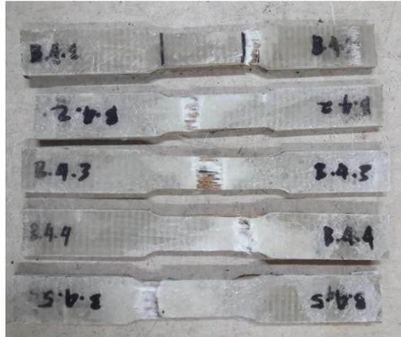
Gambar 4.13 Dokumentasi pengujian tarik variasi *core material* bilah Bambu 4 mm
