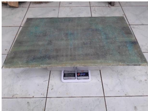
Gambar 4.1 Pengukuran berat laminasi *sandwich*
