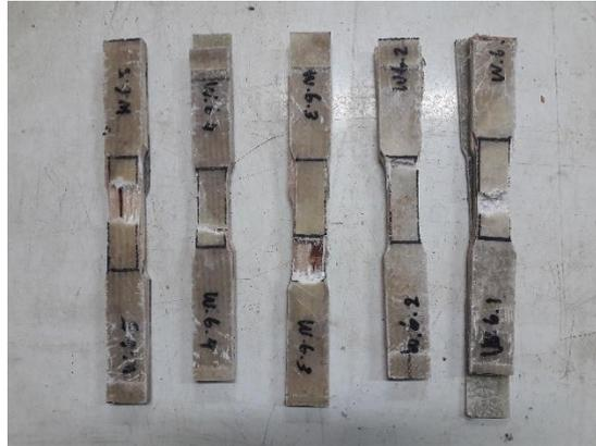
Gambar 4.7 Dokumentasi pengujian tarik variasi *core material* kayu Waru 6 mm
