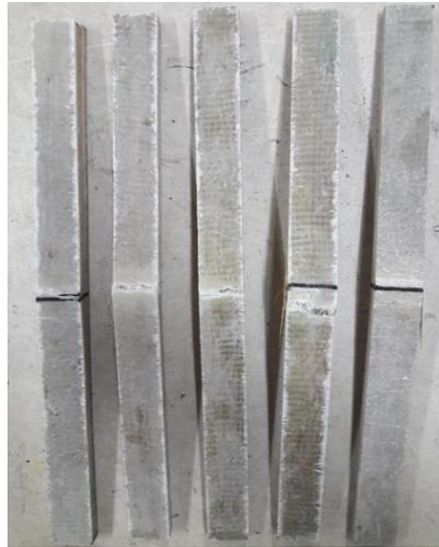
Gambar 4.23 Dokumentasi pengujian tekuk variasi *core material* kayu Waru 6 mm
