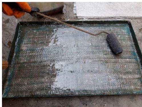
Gambar 3.10 Proses Pelapisan Resin Pada CSM 300
