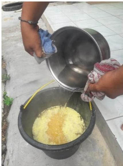
Gambar 3.6 Proses Melarutkan Belerang dan Bleng dengan Air Panas
