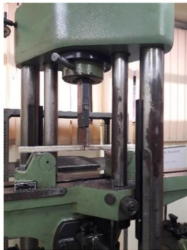
Gambar 3.16 Pengujian Tekuk
