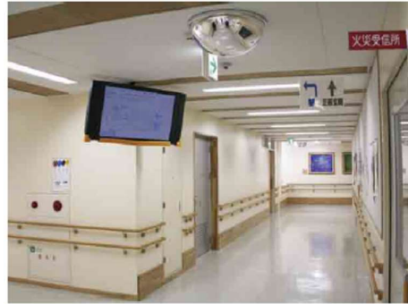
Gambar 2.54 Kaca Cembung Digunakan untuk Menghindari Tabrakan Sumber: Jun Ueno (hlm. 6)
