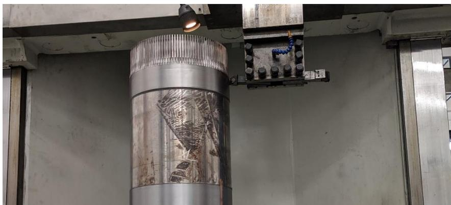
Gambar 4.17 Proses pemotongan menggunakan mesin *vertical lathe*
