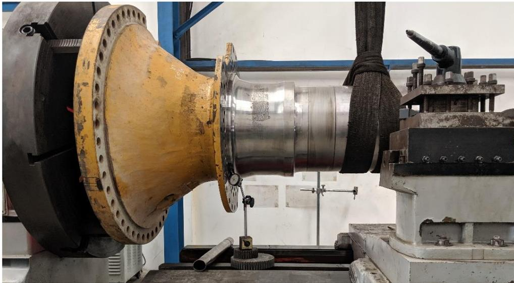
Gambar 4.11 *Check alignment* menggunakan dial
