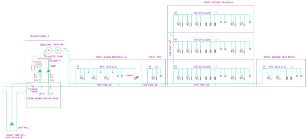
Gambar 2.40 Skema air bersih untuk gudang alat berat, gedung pelatihan, pos pantau, rumah mess 2 Sumber : Ilustrasi penulis, 2019
