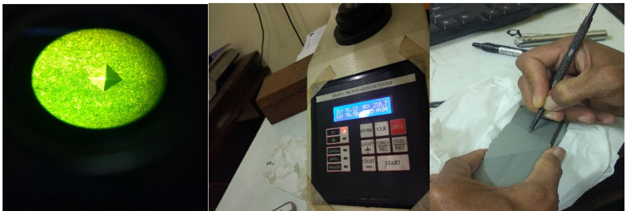
Gambar IV.9 Contoh Hasil Pengujian Vickers Hardness pada Temper Bead Rasio Heat input 1.3
