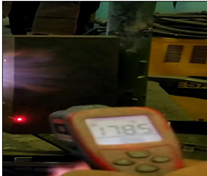
Gambar III.13 Preheat di atas 150 °C
