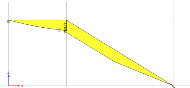
Gambar 4. 10 diagram momen balok utama tangga
