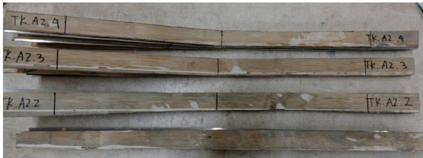
Gambar 4.11 Patahan Pada Spesimen Pengujian Kuat Tekuk Variasi Dua (TK.A2)
