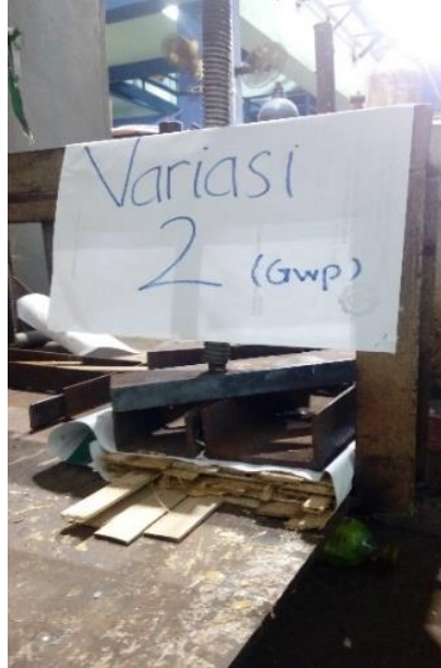
Gambar 3.13 Proses Pengepresan Papan Laminasi
