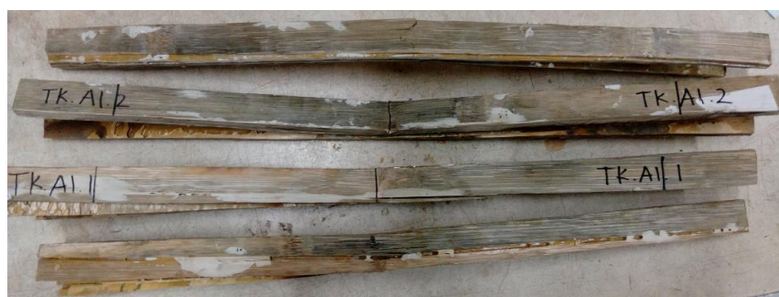
Gambar 4.9 Patahan Pada Spesimen Pengujian Kuat Tekuk Variasi Satu (TK.A1)
