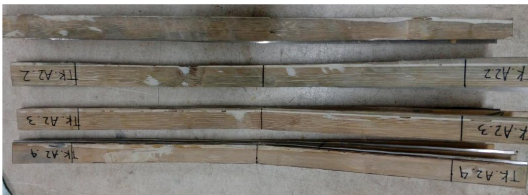
Gambar 3.19 Patahan Pada Spesimen Kuat Tekuk
