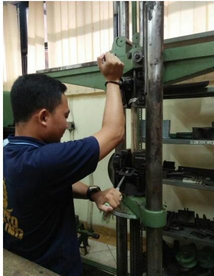
Gambar 3.16 Proses Pengujian Kuat Tarik
