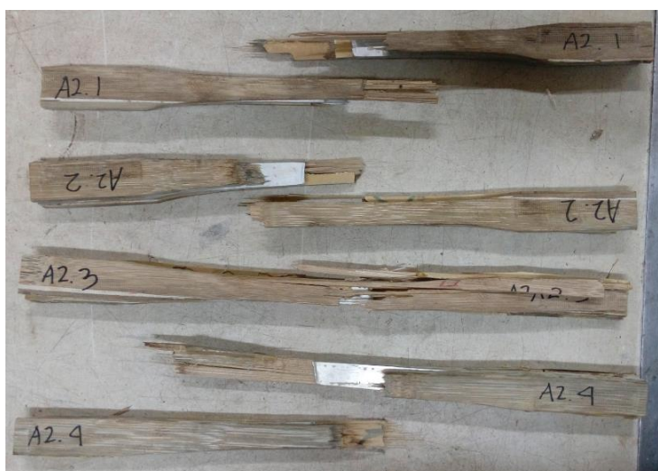
Gambar 4.5 Patahan Spesimen Uji Tarik Variasi Dua (TR.A2)
