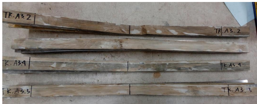
Gambar 4.13 Patahan Pada Spesimen Pengujian Kuat Tekuk Variasi Tiga (TK.A3)
