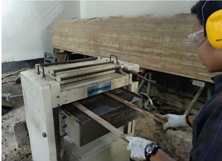
Gambar 3.4 Proses Penipisan Bilah Bambu Menggunakan Mesin Planar
