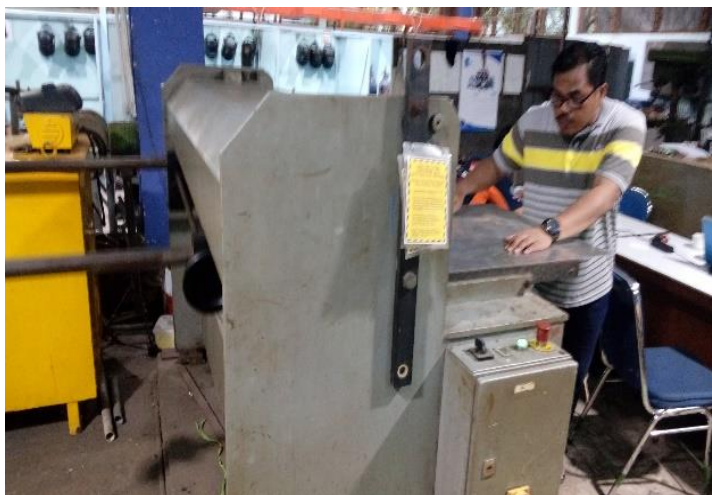
Gambar 3.8 Proses Pemotongan Aluminium Menggunakan Power Shearing Machine
