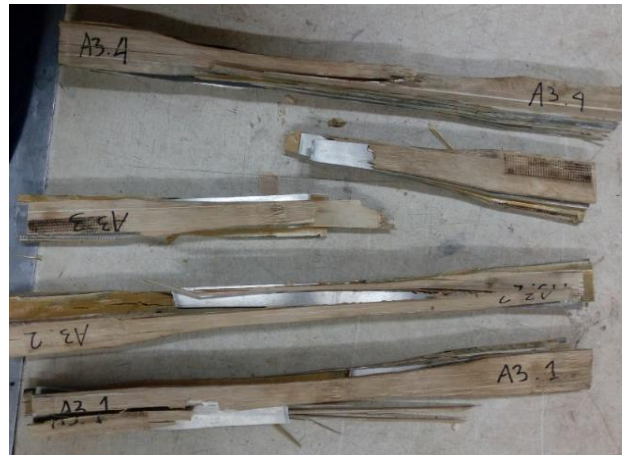
Gambar 4.7 Patahan Spesimen Uji Tarik Variasi Tiga (TR.A3)
