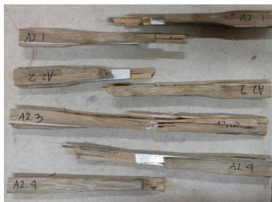
Gambar 3.17 Hasil Pengujian Kuat Tarik (TR.A2)
