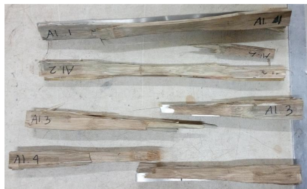
Gambar 4.3 Patahan Spesimen Uji Tarik Variasi Satu (TR.A1)
