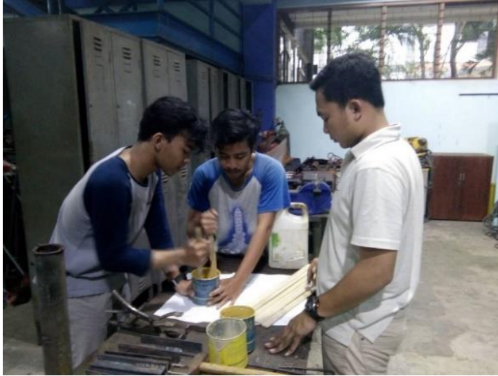
Gambar 3.11 Proses Pencampuran Lem Epoxy antara Resin-Hardener
