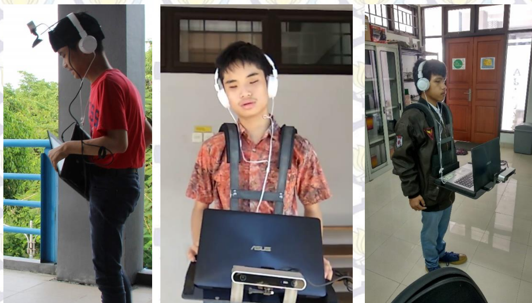
Gambar 4.3 Posisi peletakan perangkat keras terhadap pengguna tunanetra
