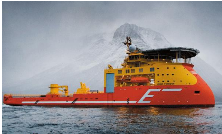
Gambar II.3 Pengaplikasian Inverted Bow pada MV. Viking Poseidon (Sumber: Ulstein, 2015)
