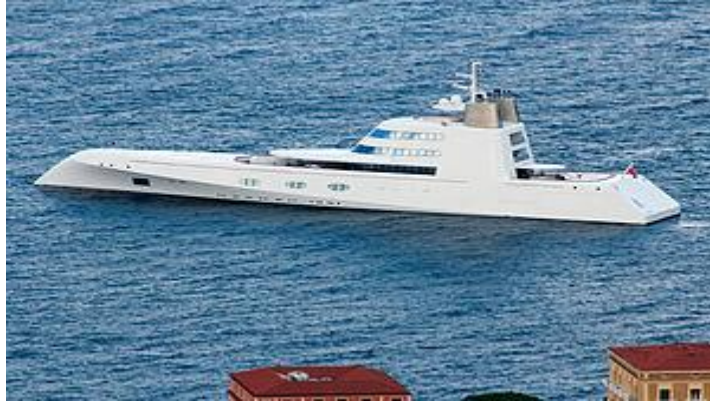
Gambar II.2 Kapal dengan Inverted bow (Marine Insight, 2015)
