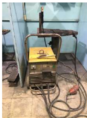
Gambar 4.3 Mesin las busur listrik
