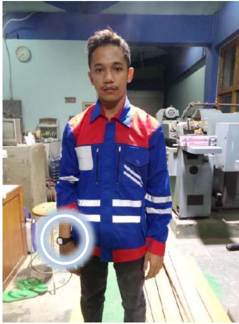
Gambar 5.4 Peletakan Sensor pada Pergelangan Tangan yang Digunakan Saat Melakukan Pengelasan
