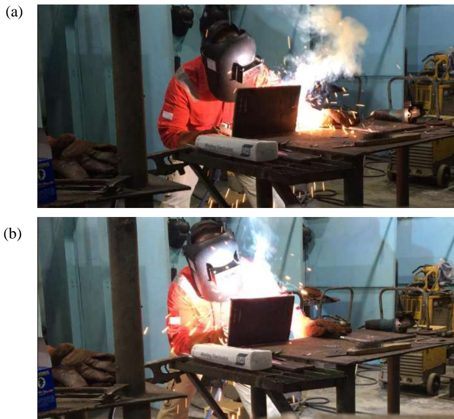
Gambar 6.4 Kegiatan Pengelasan Posisi 2G. (a) Saat memulai pengelasan, (b) Saat akan menghentikan pengelasan
