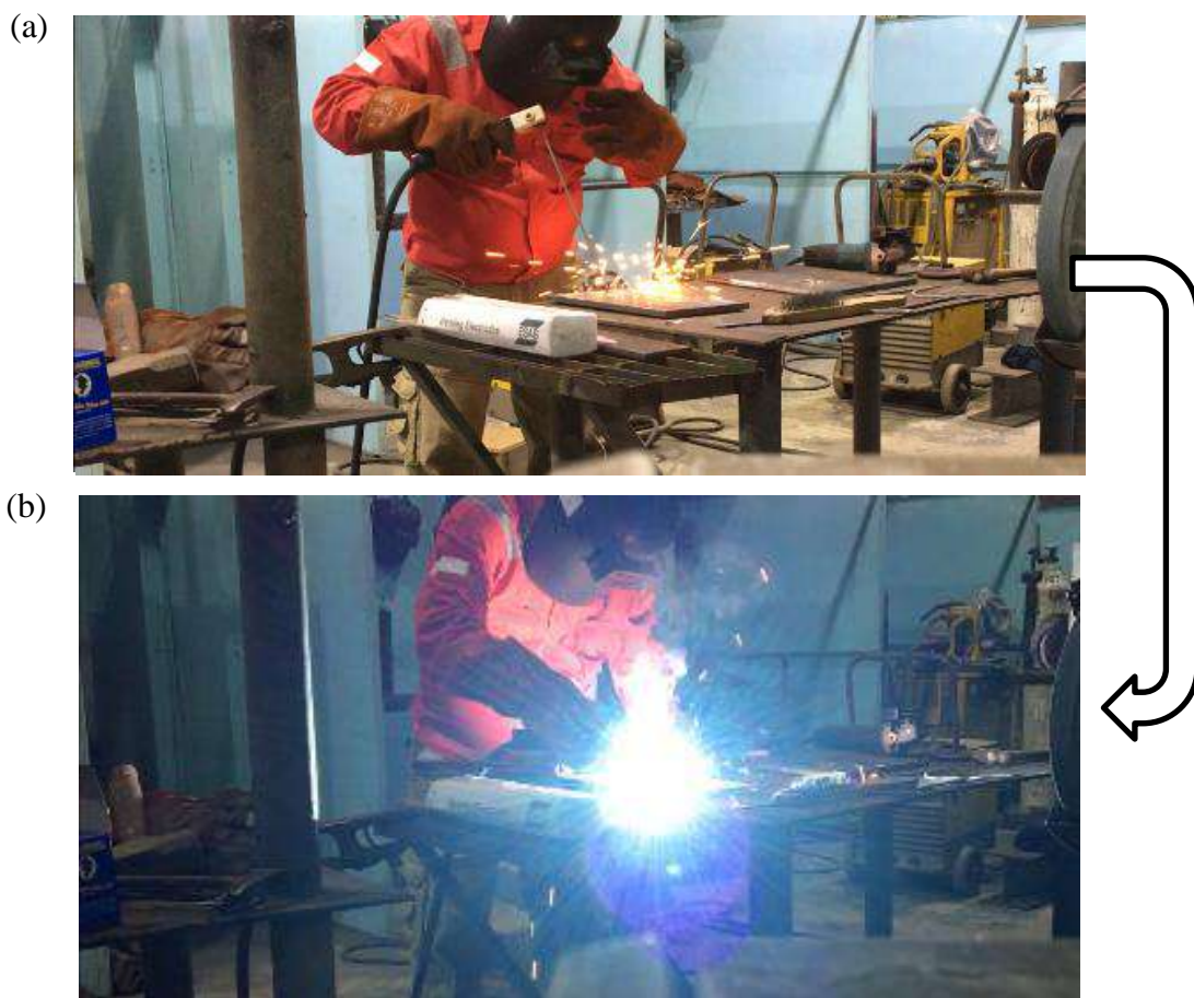
Gambar 6.1 Kegiatan Pengelasan Posisi 1G. (a) memulai penyalaan busur las, (b) saat akan menghentikan pengelasan
