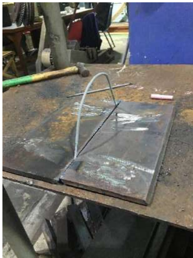
Gambar 4.12 Persiapan awal pengelasan tumpul kampuh V posisi datar dengan penahan belakang
