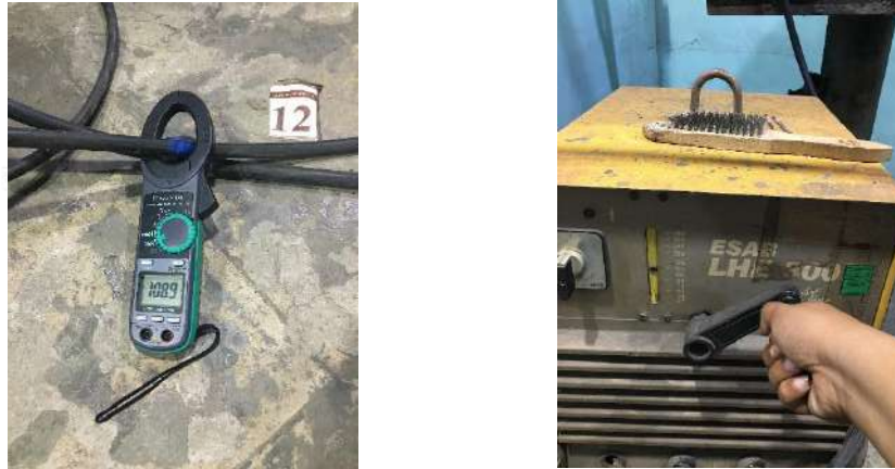
Gambar 4.7 Pemeriksaan arus mesin las busur listrik dan pengaturan arus mesin las busur listrik
