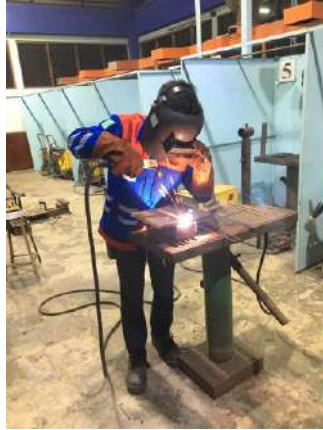
Gambar 4.9 Posisi tubuh saat penyalaan las busur listrik
