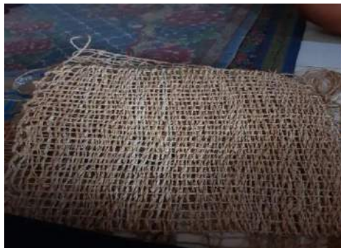
Gambar 3.5 Woven Roving dari serat kulit Pohon Waru
