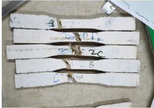
Gambar 3.21 Hasil pengujian tarik
