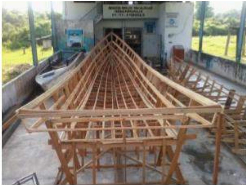
Gambar 2.14 Cetakan kapal FRP [sumber: Ardiana, Razali, Muharnis, 2014]
