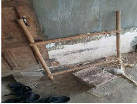
Gambar 3.4 Cetakan 50 cm x 50 cm untuk anyaman Woven Roving
