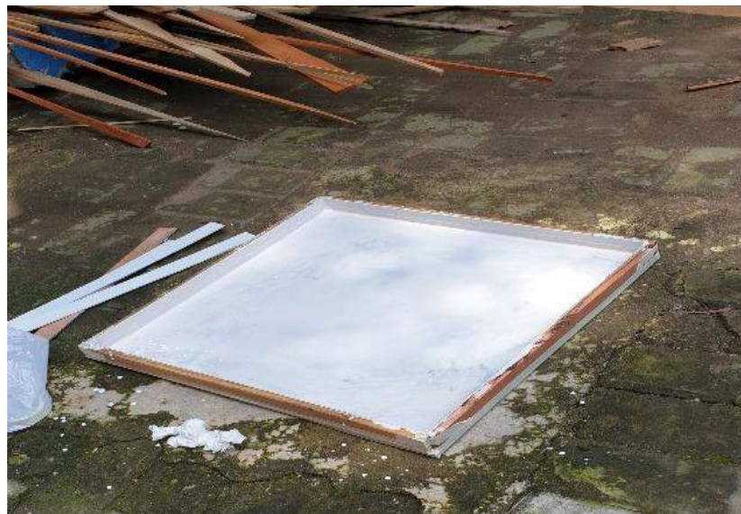
Gambar 3.12 Cetakan yang dilapisi gelcoat
