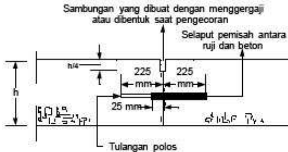
Gambar 2.22. Sambungan Susut Melintang dengan Ruji (Sumber : Pd T-14-2003)
