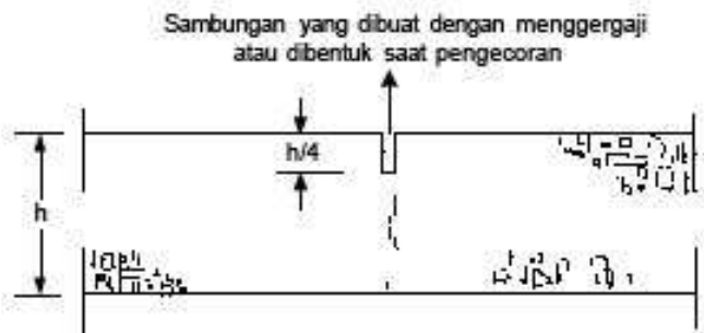
Gambar 2.21. Sambungan Susut Melintang Tanpa Ruji (Sumber : Pd T-14-2003)
