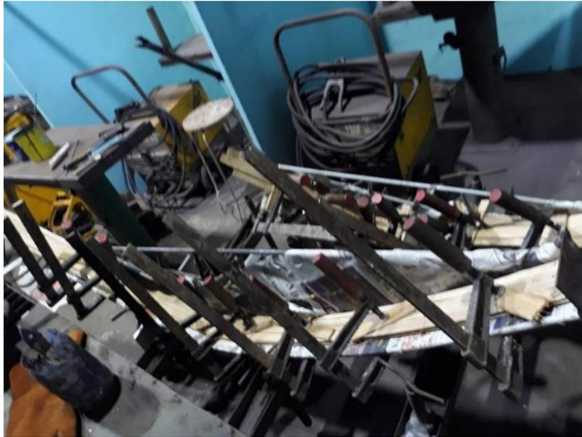
Gambar 3.5 Proses klem F pada proses pembuatan gading laminasi bambu
