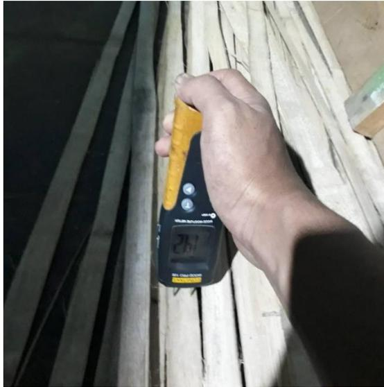
Gambar 3.53.4 Proses cek kadar air pada bambu
