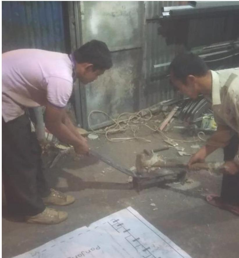
Gambar 3.3 Proses *forming* baja menjadi cetakan
