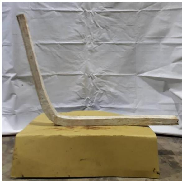
Gambar 4.9 Gading Laminasi Bambu
