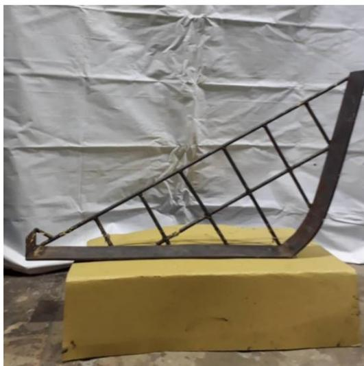
Gambar 4.8 Cetakan gading bambu secara *series*
