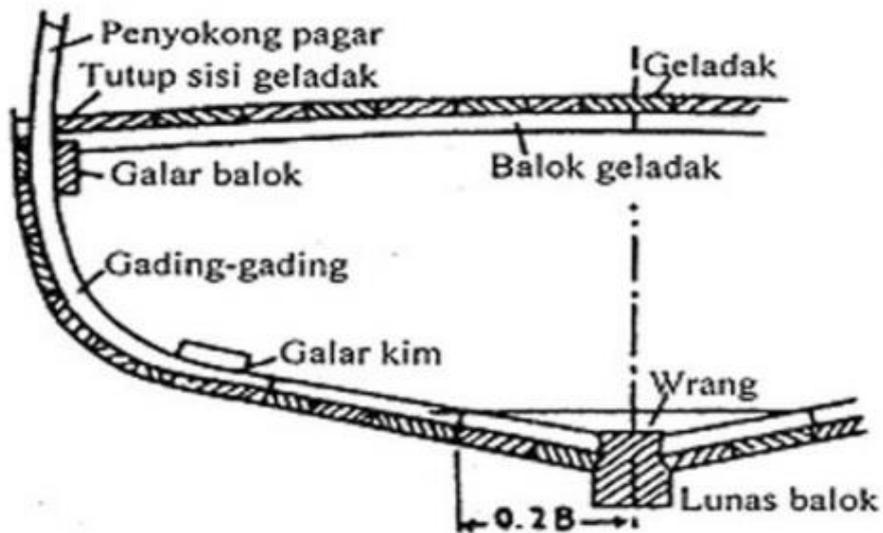
Gambar 2.5 Konstruksi Kapal Kayu
