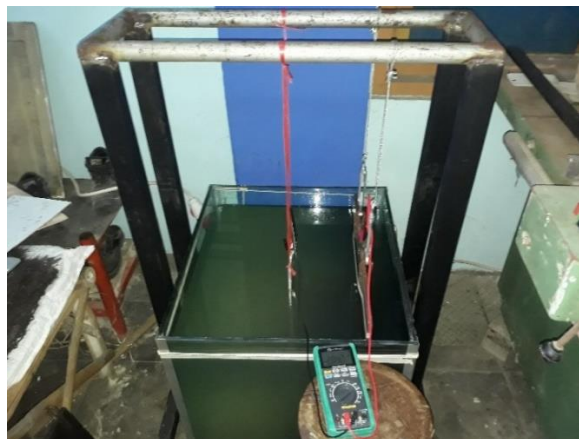
Gambar 3.20 Rangkaian pengujian menggunakan ammeter
