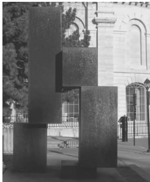
Gambar 2.11 Korosi seragam yang terjadi pada monumen logam (Sumber: Roberge, 2008)
