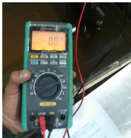
Gambar 3.18 Kalibrasi amperemeter menunjukkan angka nol
