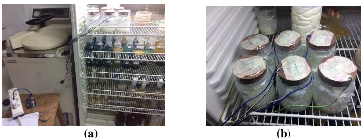
Gambar 4.2 Proses Inkubasi Yogurt dengan audiosonik, (a). Rangkaian alat yang digunakan saat inkubasi, (b). Wadah dengan speaker piezo didalamnya yang digunakan saat inkubasi
