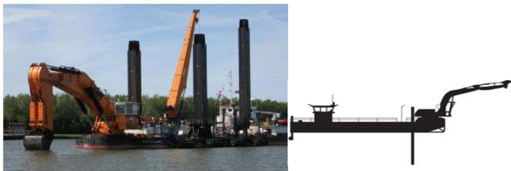
Gambar II. 4. Backhoe Dredger (Direktorat Pelabuhan dan Pengerukan, 2015)
