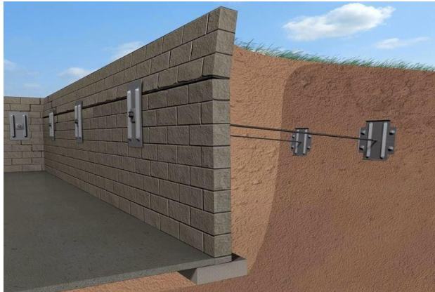
Gambar 2.2. Kegagalan konstruksi akibat tanah kembang susut pada konstruksi dinding penahan tanah
