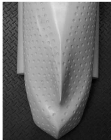
Gambar II. 14. Kapal Model Donnelly (2010) yang Telah Dicitak dengan Dimple pada Bagian Buritan Kapal (Sumber: Donnelly, 2010)
