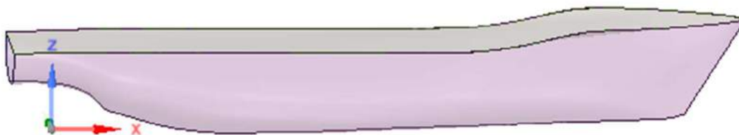
Gambar III. 5. Model 3D Kapal Pengangkut Ikan 60GT
