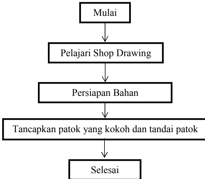
Gambar 4.4 Flow Chart Pengukuran dan Pemasangan Bowplank
