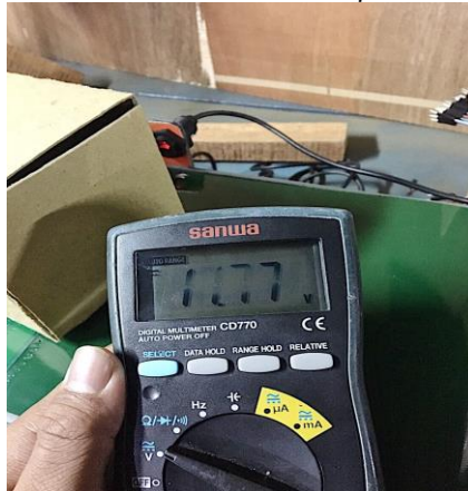
Gambar 4.4 Ilustrasi Hasil Pengujian Tegangan pada Sensor Photoelectric 1 Saat Mendeteksi Fibrete
