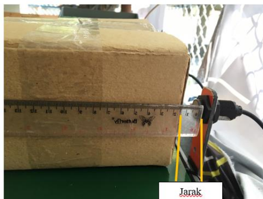
Gambar 4.15 Ilustrasi Hasil Pengujian Jarak Deteksi Sensor Photoelectric 2
