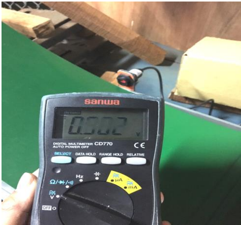
Gambar 4.5 Ilustrasi Hasil Pengujian Tegangan pada Sensor Photoelectric 2 Sebelum Mendeteksi Fibrete
