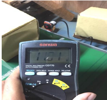
Gambar 4.6 Ilustrasi Hasil Pengujian Tegangan pada Sensor Photoelectric 2 Saat Mendeteksi Fibrete
