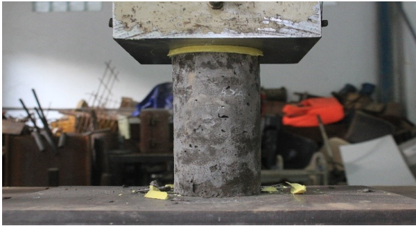
Gambar 3.12 Tes kuat tekan beton
