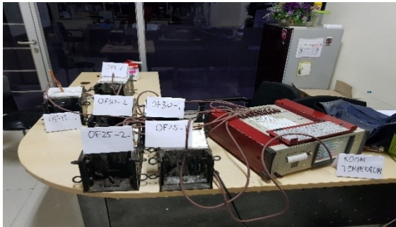
Gambar 3.9 Pengukuran suhu (panas hidrasi) beton dengan thermocouple
