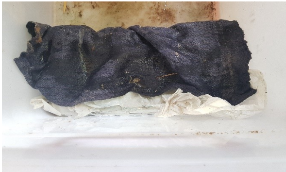
Gambar 3.11 Curing moist pada beton
