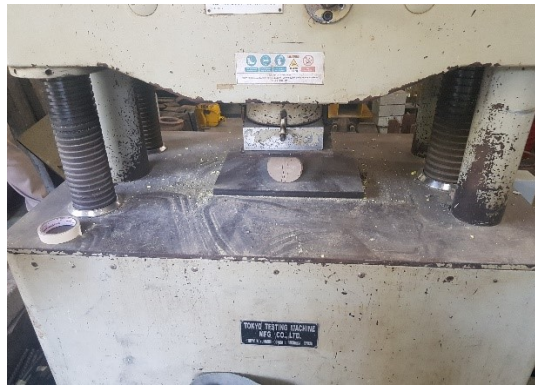
Gambar 3.13 Tes tarik belah beton
