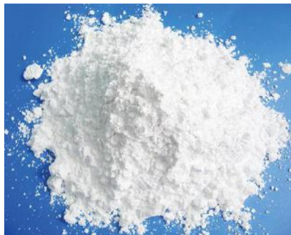
Gambar 2.2 Bentuk fisik bahan pengisi ( \text{CaCO}_3 )
