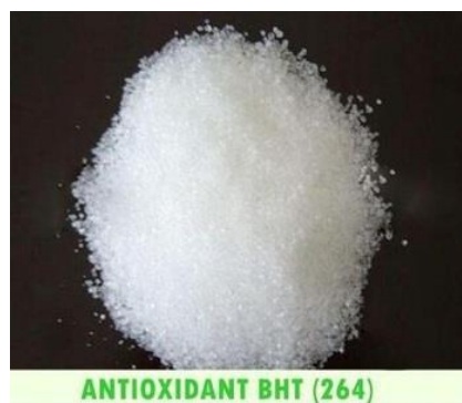
Gambar 2.5 Bentuk fisik bahan antidegradan (BHT)
