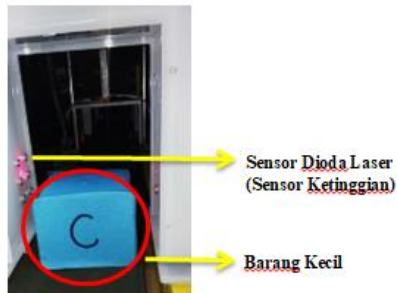
Gambar 4.32 Barang Kecil Terdeteksi Sensor Ketinggian
