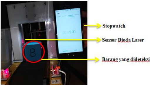
Gambar 4.26 Salah Satu Pengujian Waktu Deteksi Sensor
