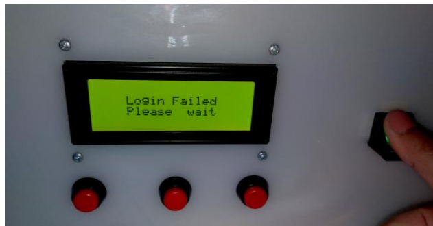
Gambar 4.8 Tampilan LCD Ketika Login Gagal
