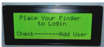
Gambar 4.28 Tampilan Awal Perintah Login di LCD
