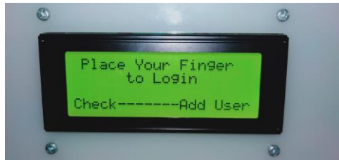
Gambar 4.6 Tampilan Awal LCD untuk Login
