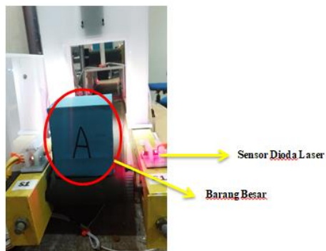
Gambar 4.43 Barang Besar Terdeteksi Sensor di Konveyor 1
