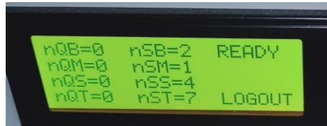
Gambar 4.11 Tampilan Ketika Semua Sensor Mendeteksi
