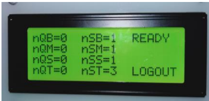
Gambar 4.47 Tampilan LCD saat Barang Terdeteksi Sensor
