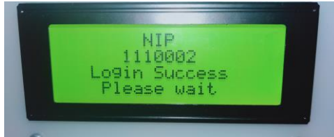
Gambar 4.7 Tampilan LCD Ketika Login Berhasil
