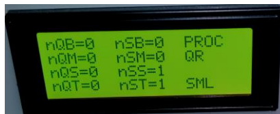
Gambar 4.25 Tampilan LCD Saat Sensor Mendeteksi Barang
