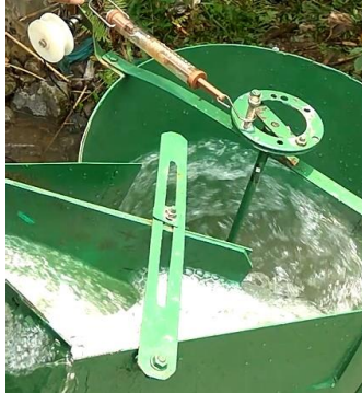
Gambar 3.13 Pengukuran Torsi dengan Neraca Pegas
