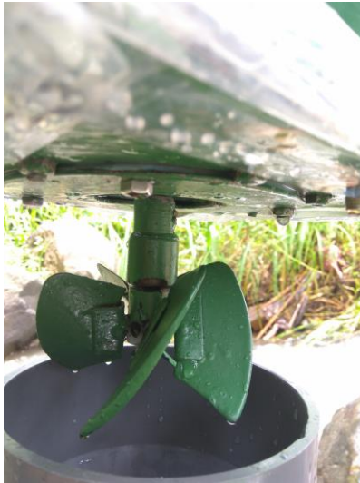
Sudu Jalan yang Telah Terpasang
