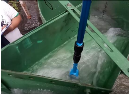
Gambar 3.11 Pengukuran Kec. Air dengan Current Meter
