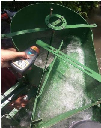
Gambar 3.12 Pengukuran Putaran Poros dengan Tachometer
