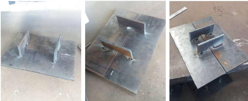
**Gambar 3.8** Proses *fitting* pada masing-masing variasi jarak *stopper* (dari kiri variasi jarak *stopper* 200 mm, 150 mm dan 100 mm)
