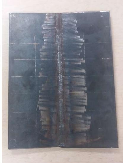
**Gambar 3.10** Objek pembanding berupa sambungan pelat tanpa *stopper*
