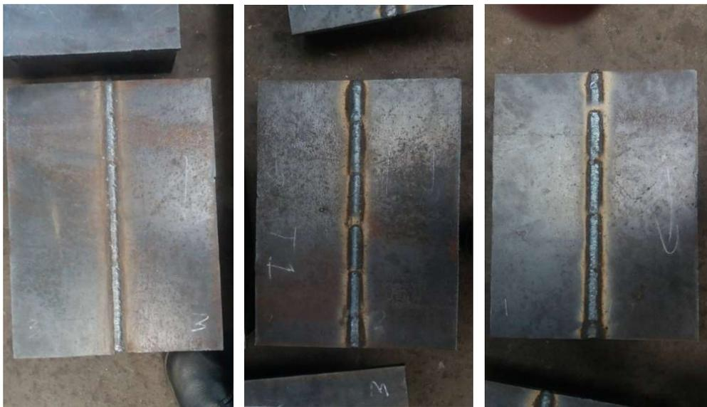
**Gambar 3.9** Tampak atas setelah proses pengelasan (dari kiri variasi jarak *stopper* 200 mm, 150 mm dan 100 mm)
