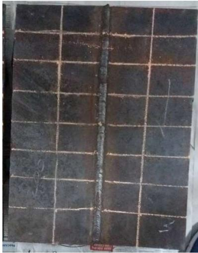
**Gambar 3.12** Titik titik pengukuran distorsi sudut
