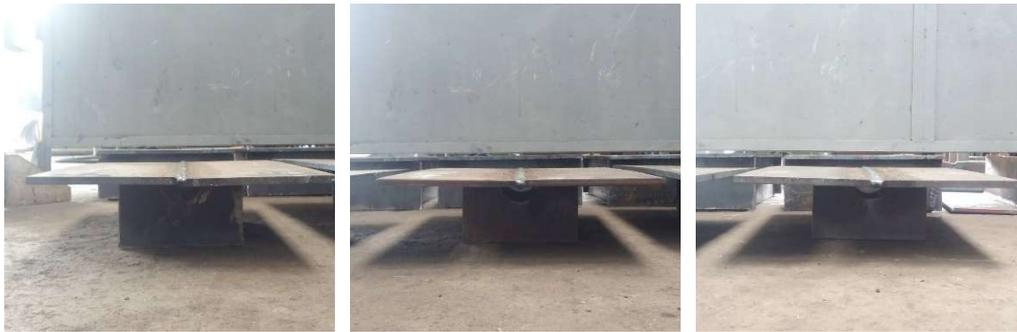
**Gambar 4.1** Tampak depan hasil pengelasan pelat baja A36 (dari kiri variasi jarak *stopper* 200mm, 150mm dan 100mm)
