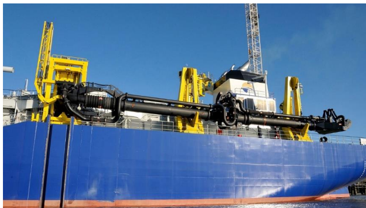
Gambar 2.25. Gantry (kuning) pada kapal keruk
