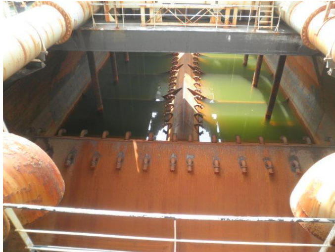
Gambar 2.18. Tampilan hopper dengan bottom door (Sumber: Captains Voyage Forum, 2012)
