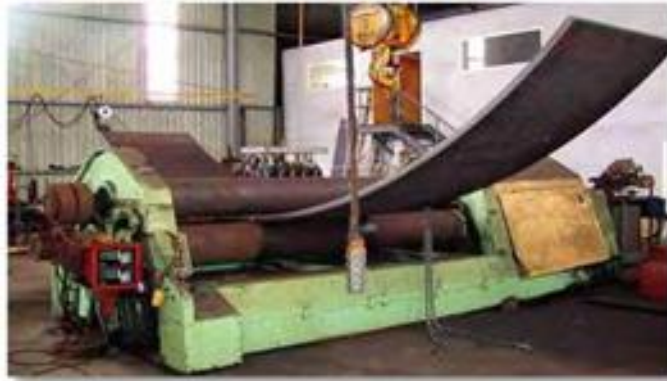
Gambar 2.5 Proses Pembentukan Dengan Mesin Bending (Sahri, 2015)
