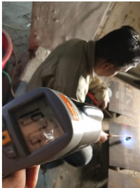
Gambar 3.17 Pengukuran suhu menggunakan thermometer infrared .
