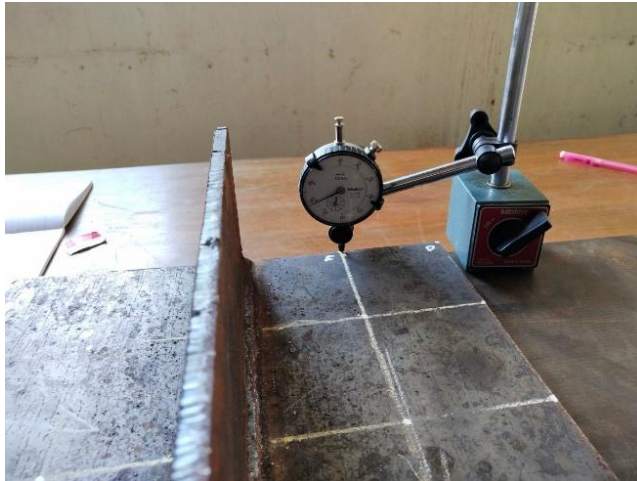
Gambar 3.7 Proses pengukuran spesimen dengan dial indicator .
