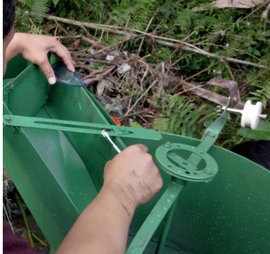
Gambar 3.12 Busur untuk mengukur besar sudut inlet
