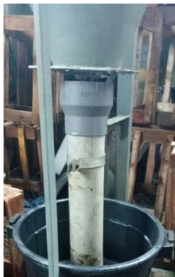
Gambar 3.4 Draft tube dengan pipa PVC
