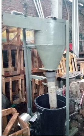
Gambar 3.5 Hasil las rotation tank dan saluran masuk
