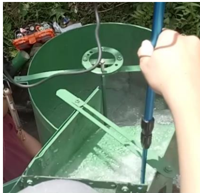
Gambar 3.11 Current meter pada saat proses pengukuran
