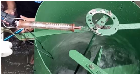
Gambar 3.10 Pengukuran gaya dengan neraca pegas
