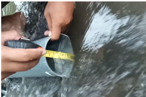
Gambar 3.13 Pengukuran ketinggian air dengan meteran
