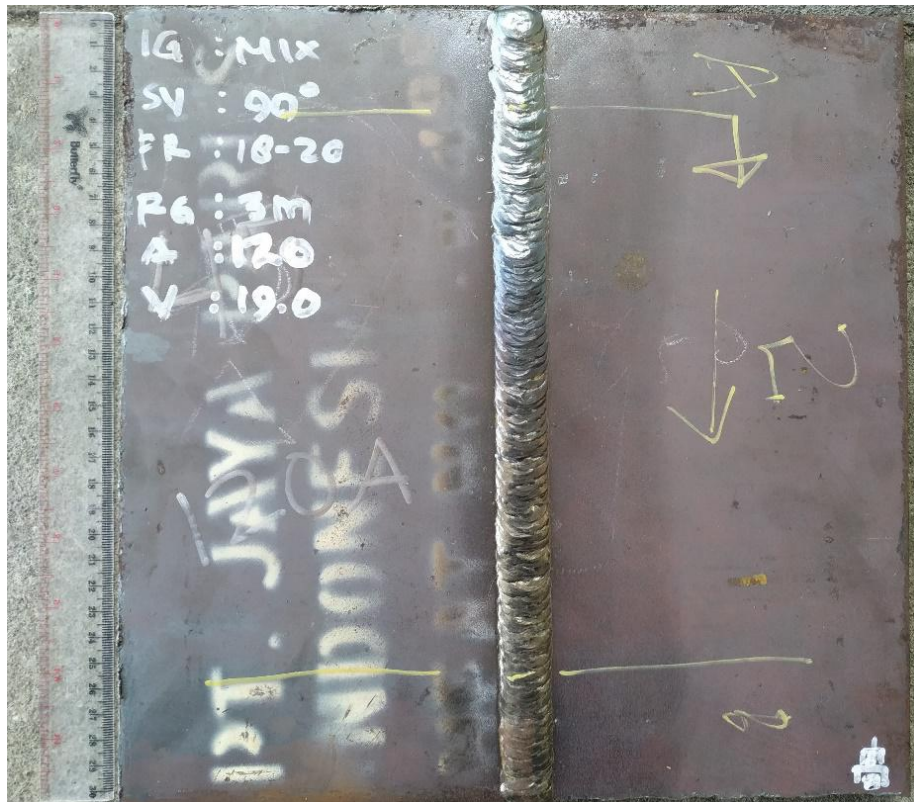
Gambar 4. 10 Sebelum dan Sesudah Dilakukan Pengelasan 90^\circ dan Arus 120 A
