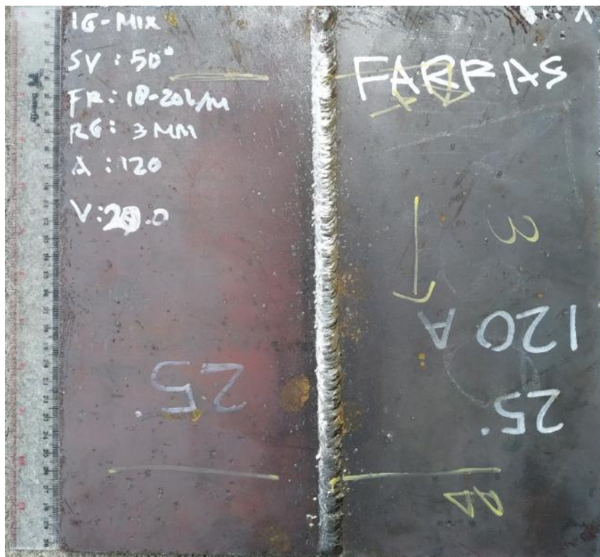
Gambar 4. 2 Sebelum dan Sesudah Dilakukan Pengelasan 50° dan Arus 120 A
