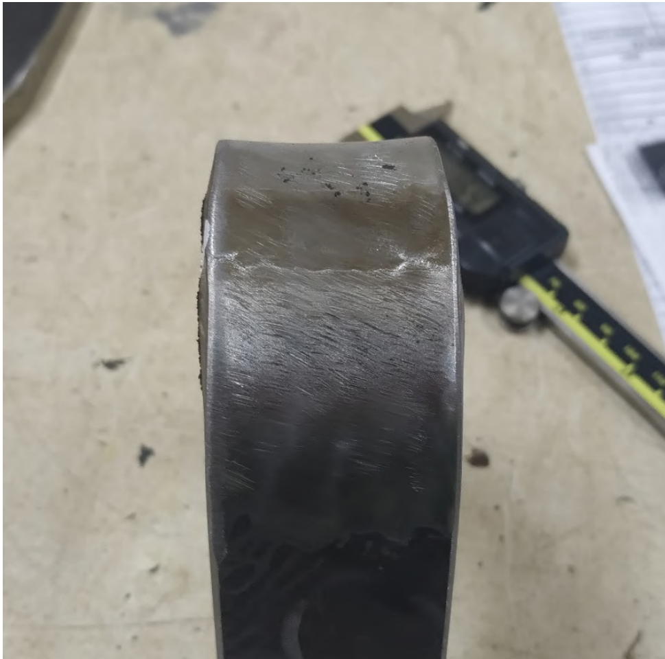
Gambar 4. 19 Hasil Pengujian Tekuk Pengelasan 90^\circ dan Arus 160 A
