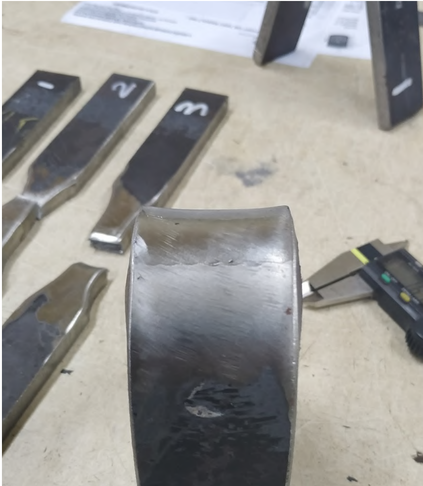
Gambar 4. 16 Hasil Pengujian Tekuk Pengelasan 70^\circ dan Arus 120 A
