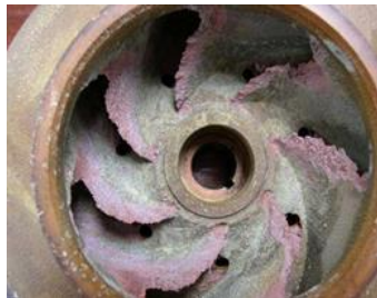
Gambar 2.5 Korosi Akibat Erosi
